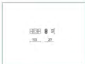
06KS909C0 B89 Conector de 4 vías IP68
