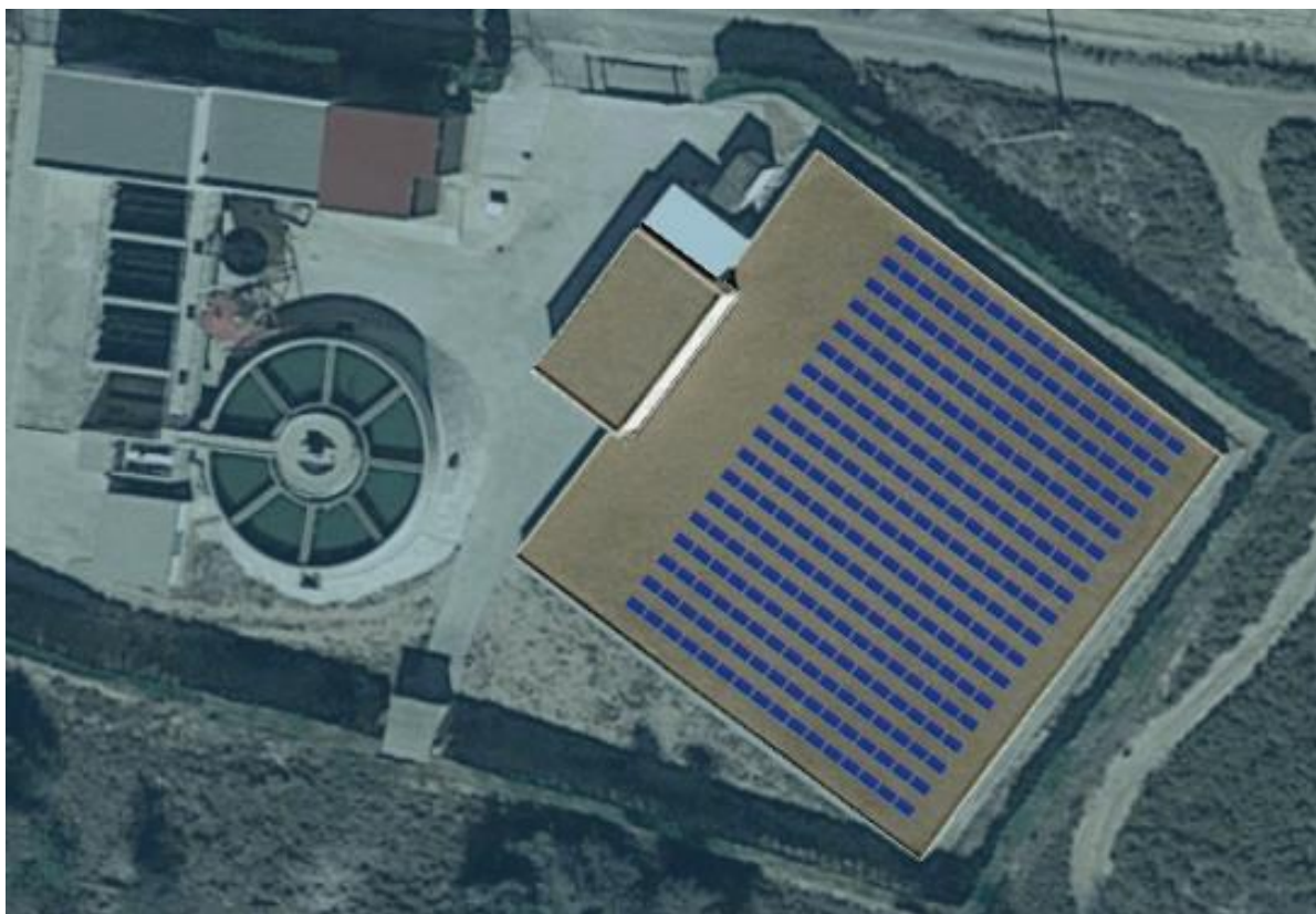
Figura nº3: Distribución Placas solares proyectadas 2D – 125 kW
