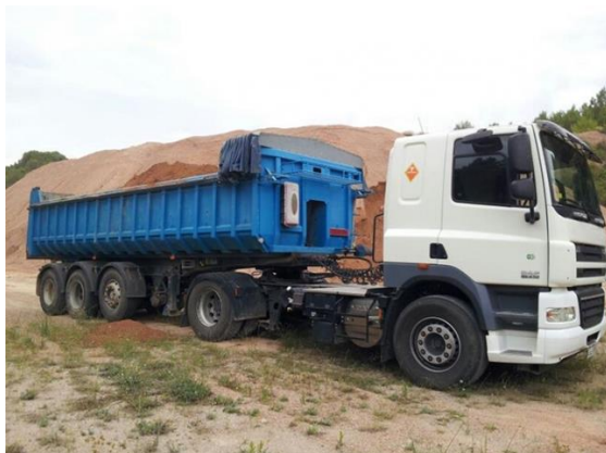
Camión bañera para transporte de material desde cantera a pie de obra y dumper para transporte de materiales (áridos, tierras excavadas, caños...) dentro de la obra
