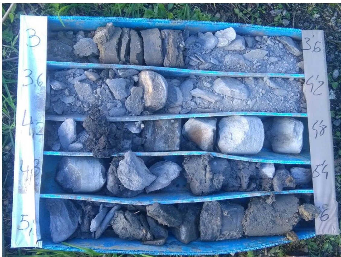
Sondeo de reconocimiento, de 3 a 6 m.
