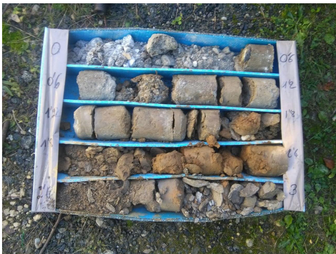
Sondeo de reconocimiento, de 0 a 3 m.
