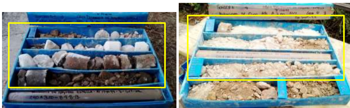
Ilustración 5: Aspecto de los niveles de rellenos en testigo de sondeos (sondeos 3 y 4).
