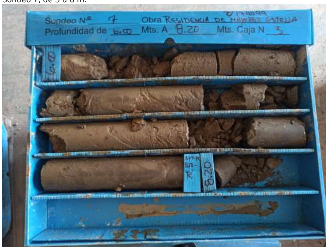
Sondeo 7, de 6 a 9 m.
