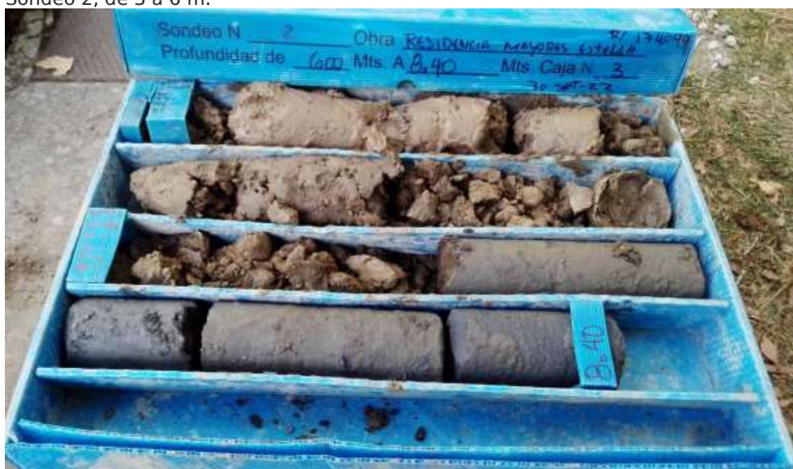
Sondeo 2, de 6 a 9 m.
