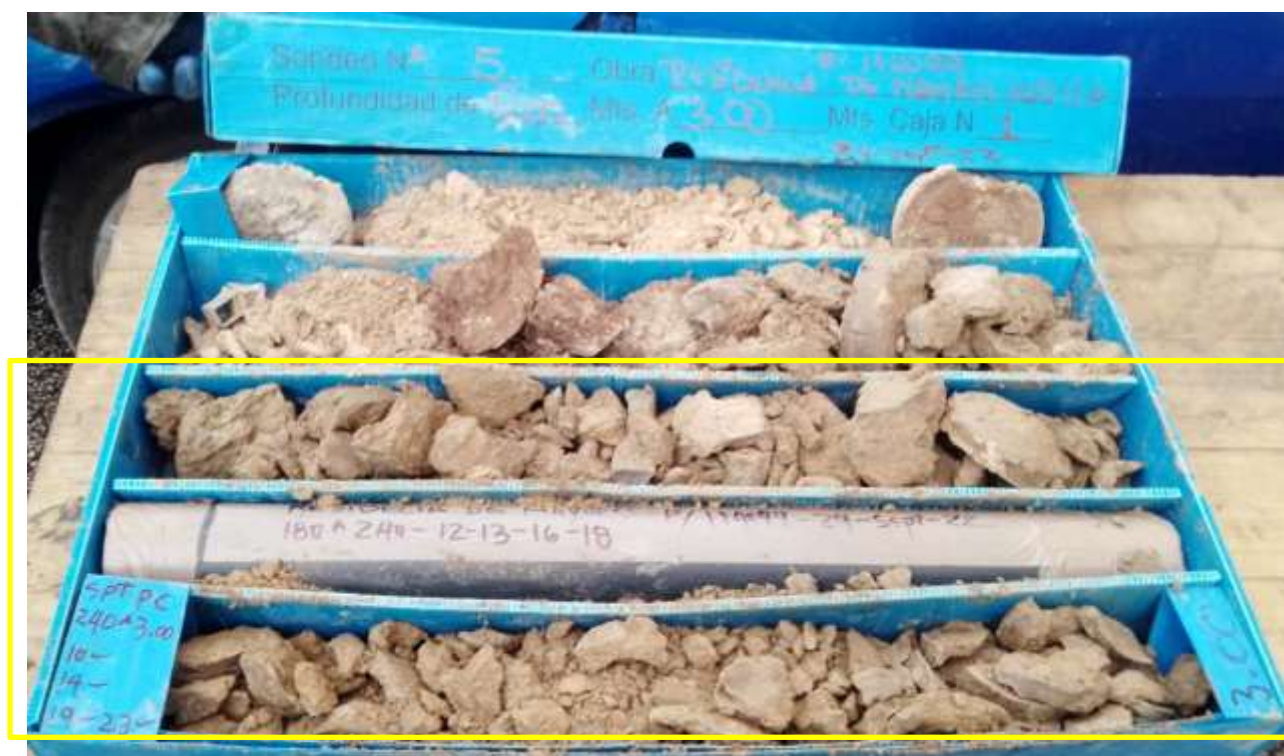
Ilustración 7: Aspecto de las arcillas del tramo de alteración en testigo de sondeo.
