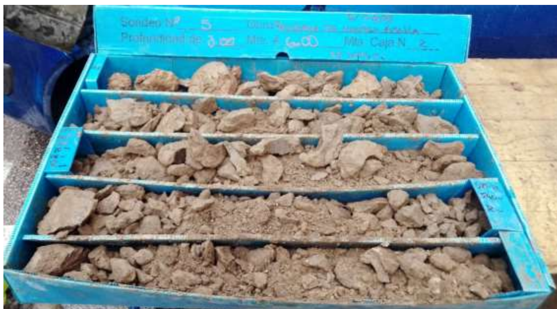
Sondeo 5, de 3 a 6 m.
