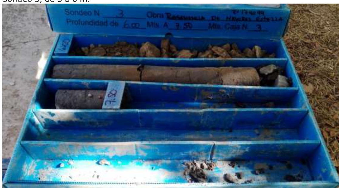
Sondeo 3, de 6 a 9 m.
