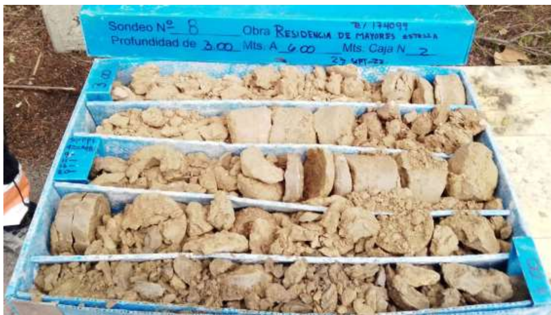
Sondeo 8, de 3 a 6 m.
