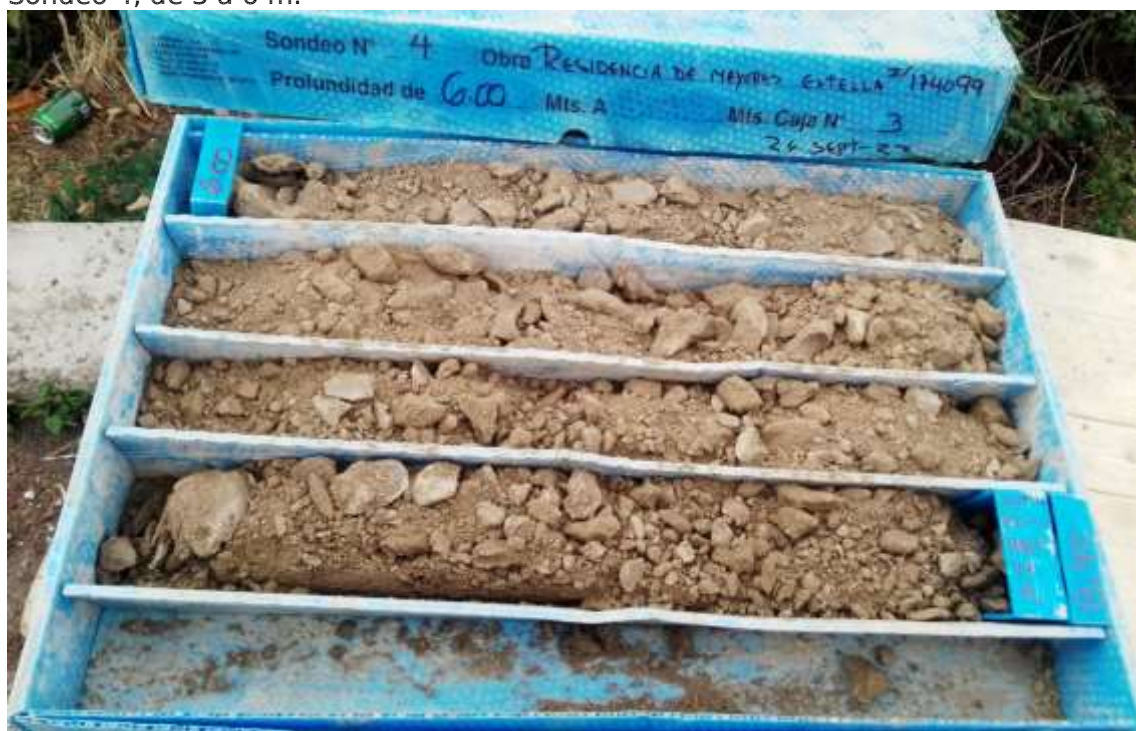
Sondeo 4, de 6 a 9 m.
