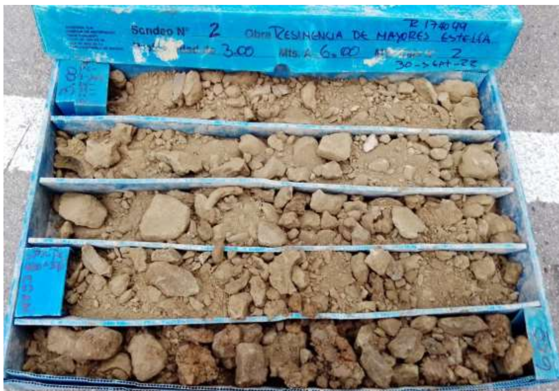
Sondeo 2, de 3 a 6 m.
