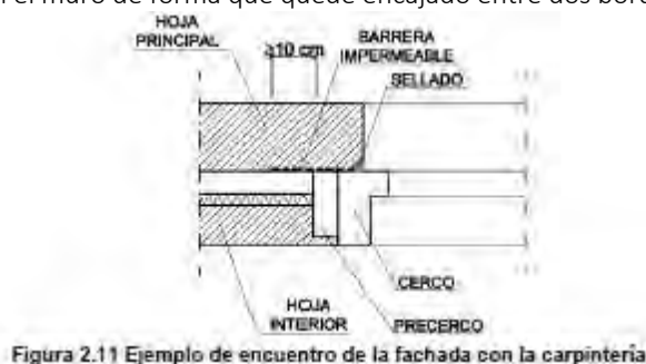
Figura 2.11 Ejemplo de encuentro de la fachada con la carpintería
