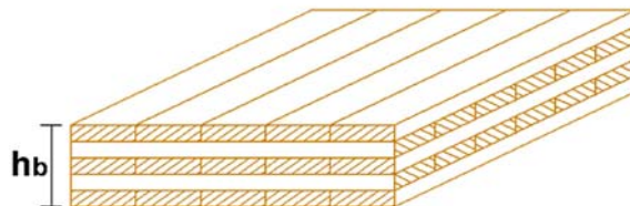
Figura: Características geométricas de forjado CLT
