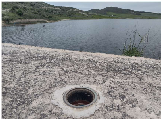
Imágenes 3 y 4. Detalle de piezómetros del dique en los que se instalar las sondas de medición de nivel de aguas subterráneas.
