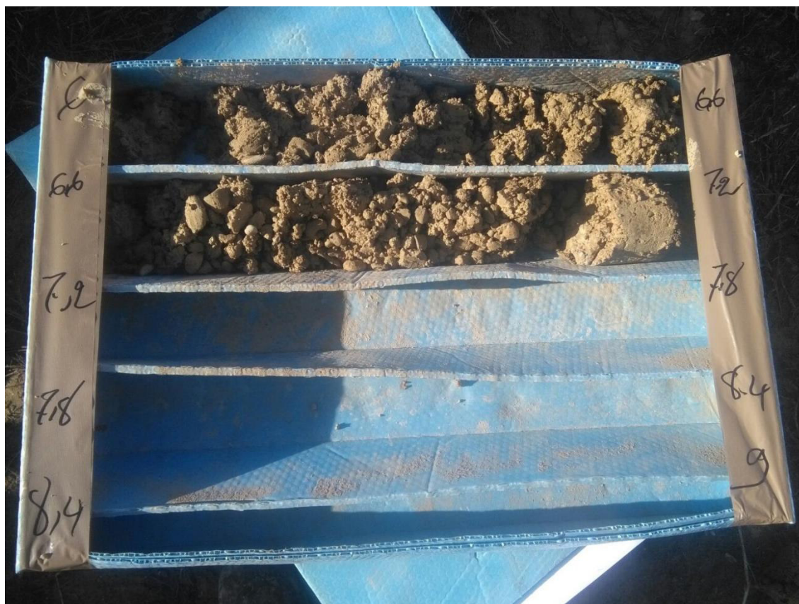
Sondeo de reconocimiento, de 6 a 9 m.
