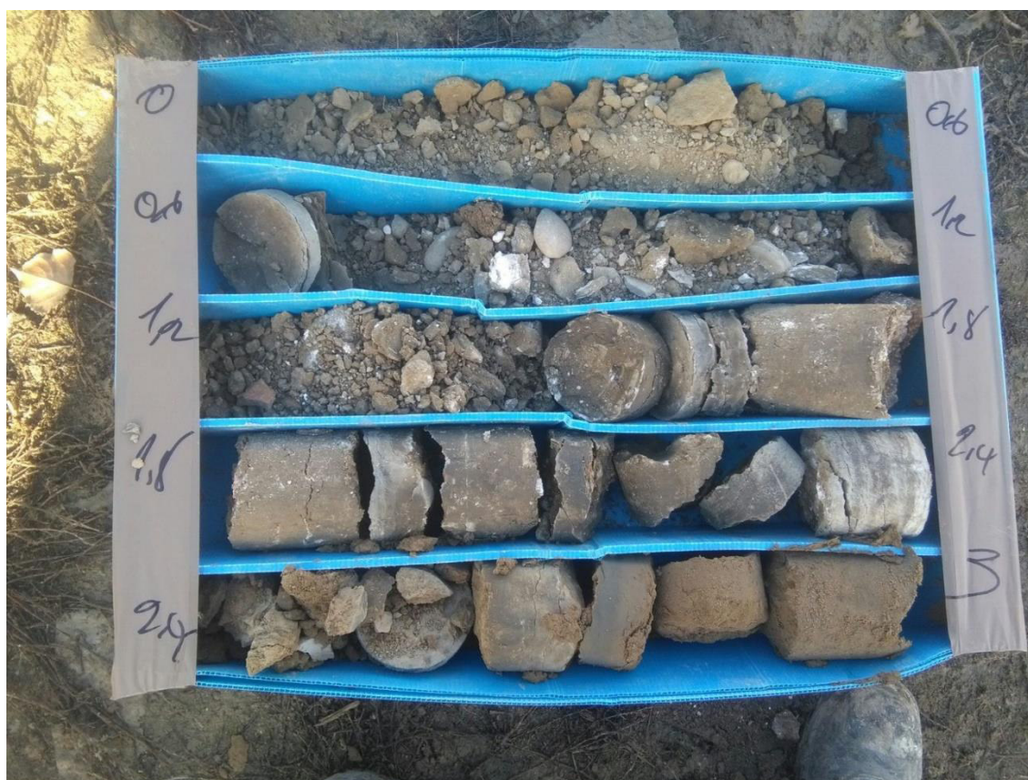
Sondeo de reconocimiento, de 0 a 3 m.
