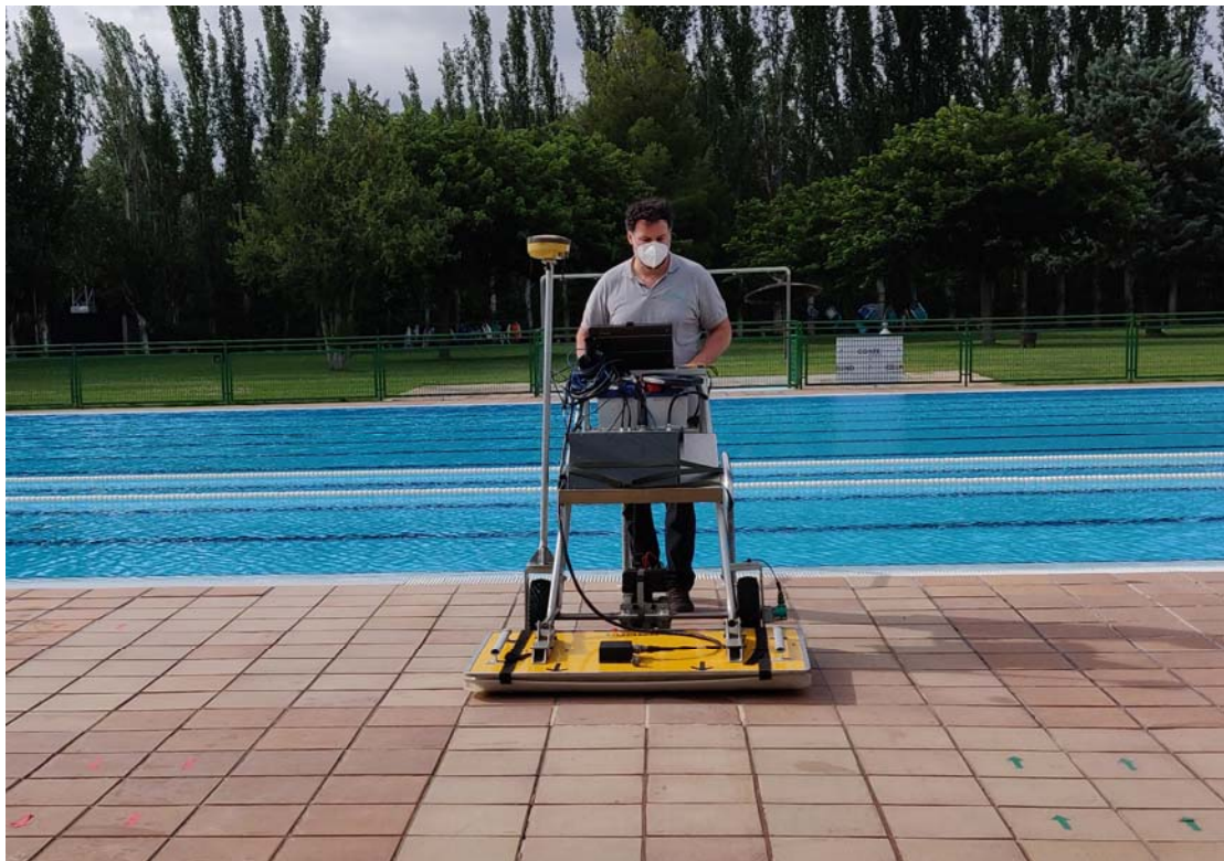
Figura 2. Detalle del equipo de geo-radar 3D con la antena de 12 canales montada en un carro manual. En la imagen se observa también el receptor GPS montado sobre un jalón.
