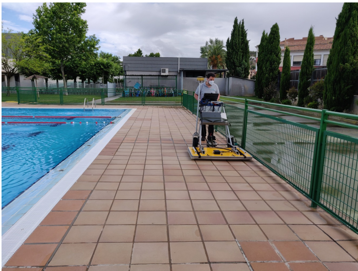
Figura 5. Momento en el que se tomaron las medidas en la zona de playa Geo-Radar 3D multifrecuencia.
