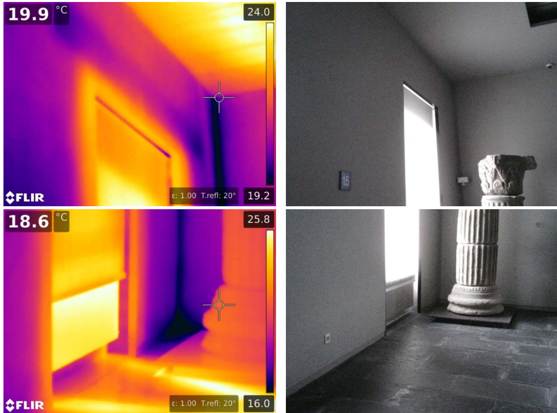
Fig.45. Termografías e imagen digital interiores de hueco de sala principal (18/11/2019)
