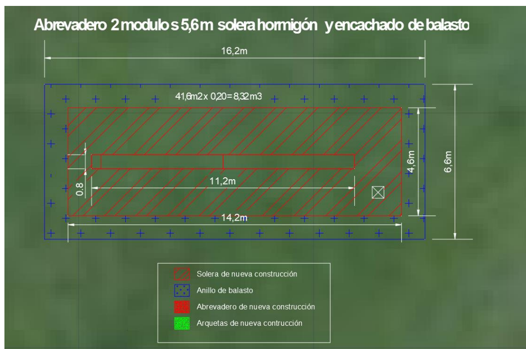
Ilustración 8: Croquis abrevadero 2 módulos
