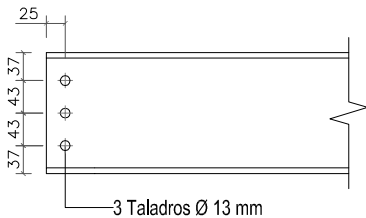
Detalle del extremo de la viga secundaria (b) IPE-160
