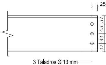
Detalle del extremo de la viga secundaria (a) IPE-160
