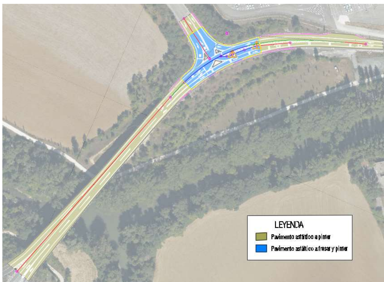
Figura 1. Zonas de rehabilitación de firme
