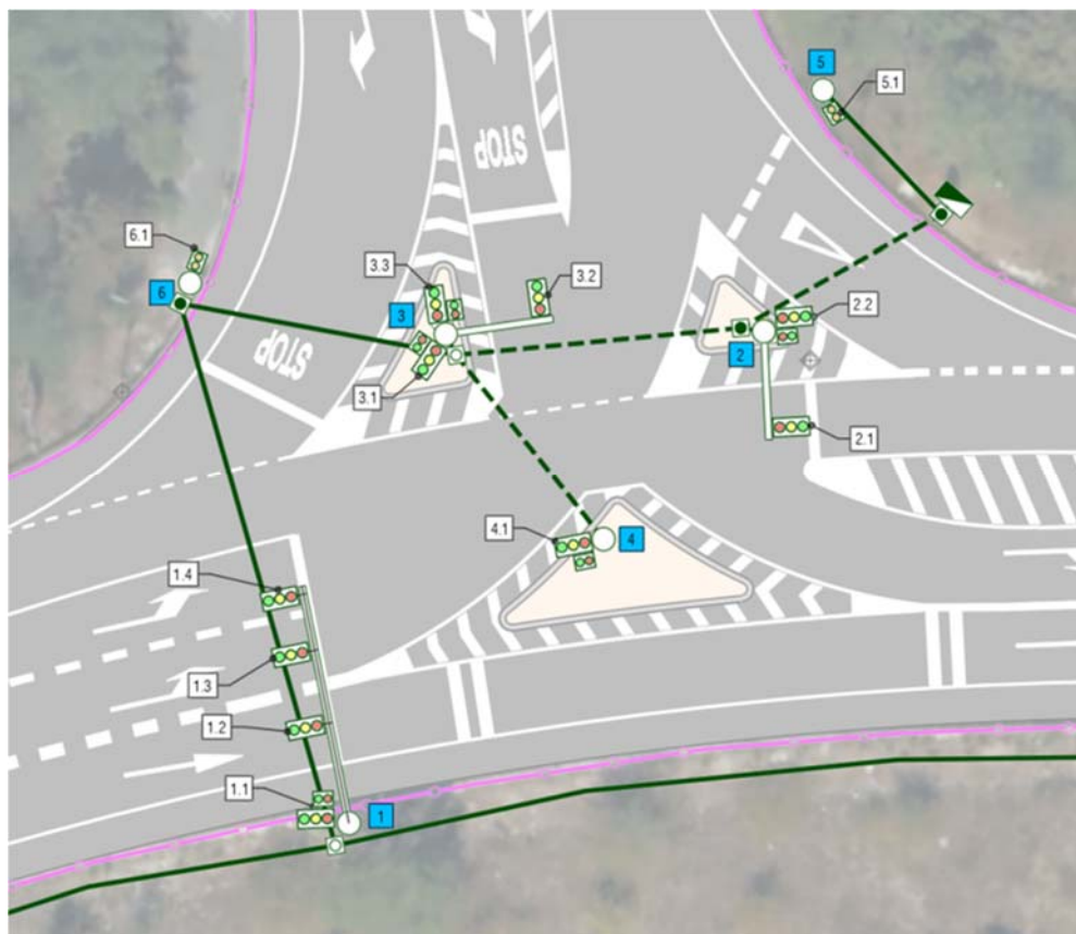
Imagen 3. Detalle de semaforización la intersección NA-30 y Landaben
