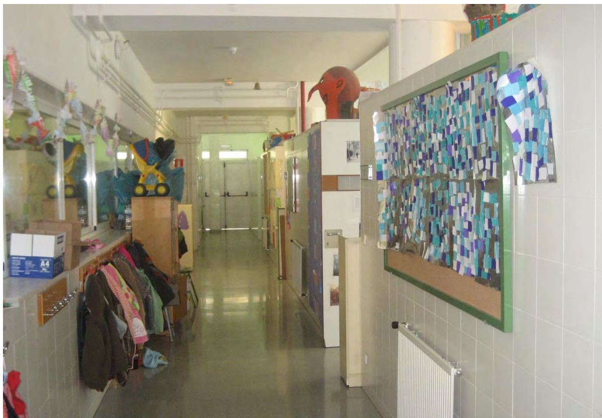
Vista del corredor central de planta primera: Itinerario accesible, que conecta el acceso accesible a la planta con todas las aulas. La anchura es de 1,50 m.
