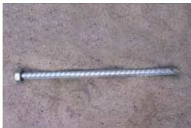
sobre tierra o asfalto: con picas de acero de 80 cm.
