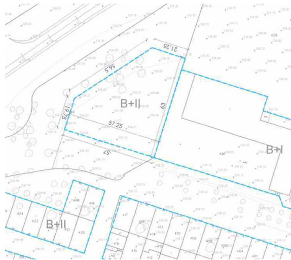
PLANO DE ALINEACIONES, ALTURAS Y RASANTES. Se grafía la alineación máx. y altura máx.= B+II
