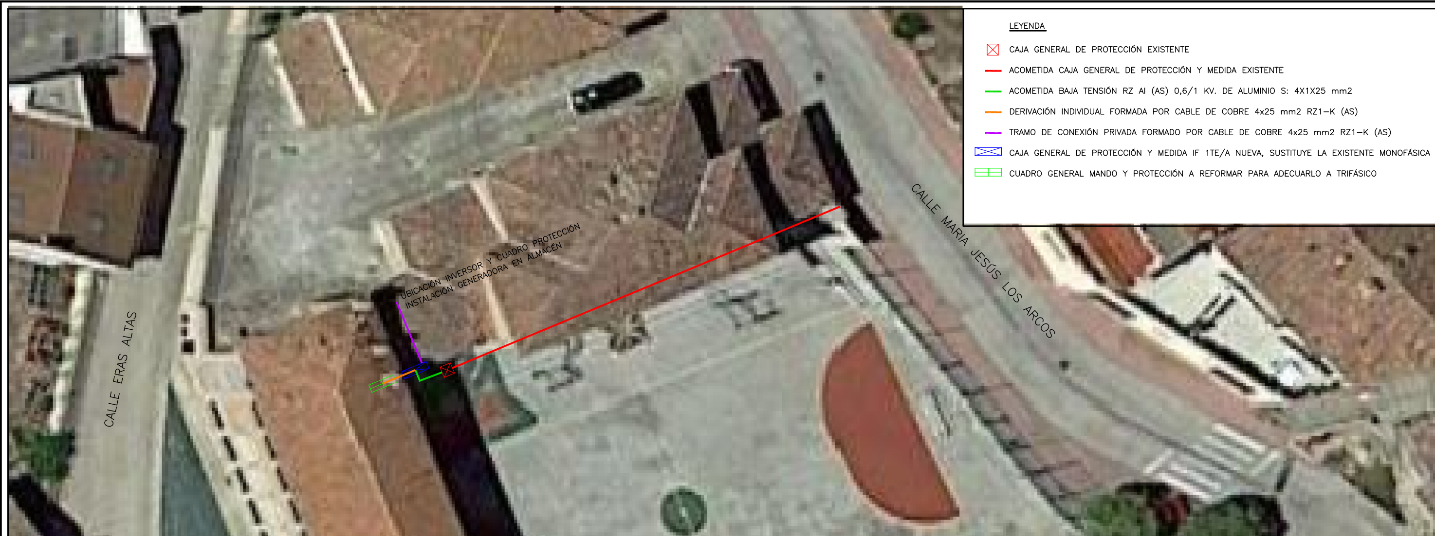
ESQUEMA DE CONEXIÓN AUTOCONSUMO COLECTIVO CON EXCEDENTES A COMPENSACIÓN (GENERACIÓN EN RED INTERIOR) PC+PG EN PARALELO RED BT i-DE-distribución
