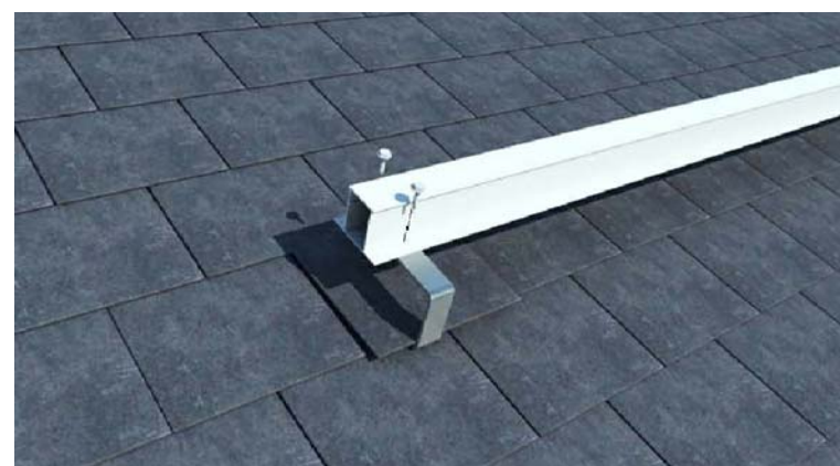
DETALLE INSTALACIÓN COPLANAR CUBIERTA TEJA MODULOS FOTOVOLTAICOS
