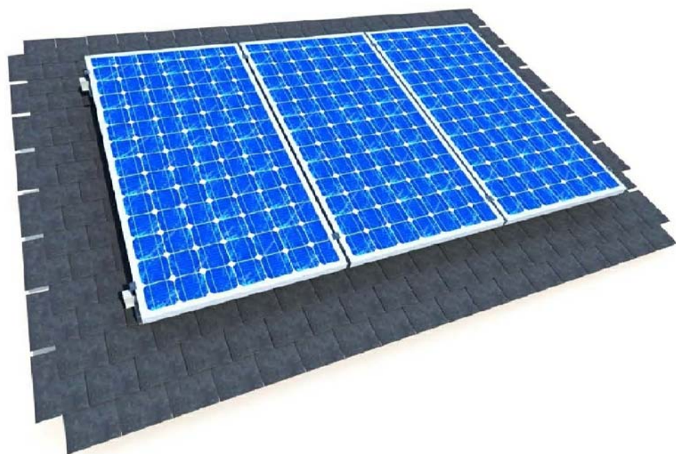
DETALLE INSTALACIÓN COPLANAR CUBIERTA TEJA MODULOS FOTOVOLTAICOS
