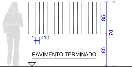
Disposición vinilos antiimpacto en vidrios
