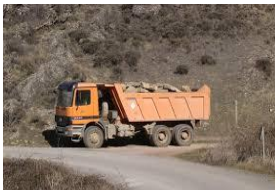
Camión dumper traccionado
