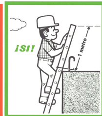
HACER TRASPASAR LAS ESCALERAS POR LO MENOS UN METRO POR ENCIMA DEL PISO DE TRABAJO AL QUE DAN PASO
