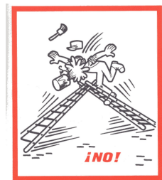
IMPEDIR QUE LAS ESCALERAS DOBLES SE DESLICEN, POR MEDIO DE CADENILLAS O CUERDAS. NO USAR NUNCA EL ÚLTIMO PELDAÑO.
