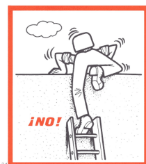
HACER TRASPASAR LAS ESCALERAS POR LO MENOS UN METRO POR ENCIMA DEL PISO DE TRABAJO AL QUE DAN PASO
