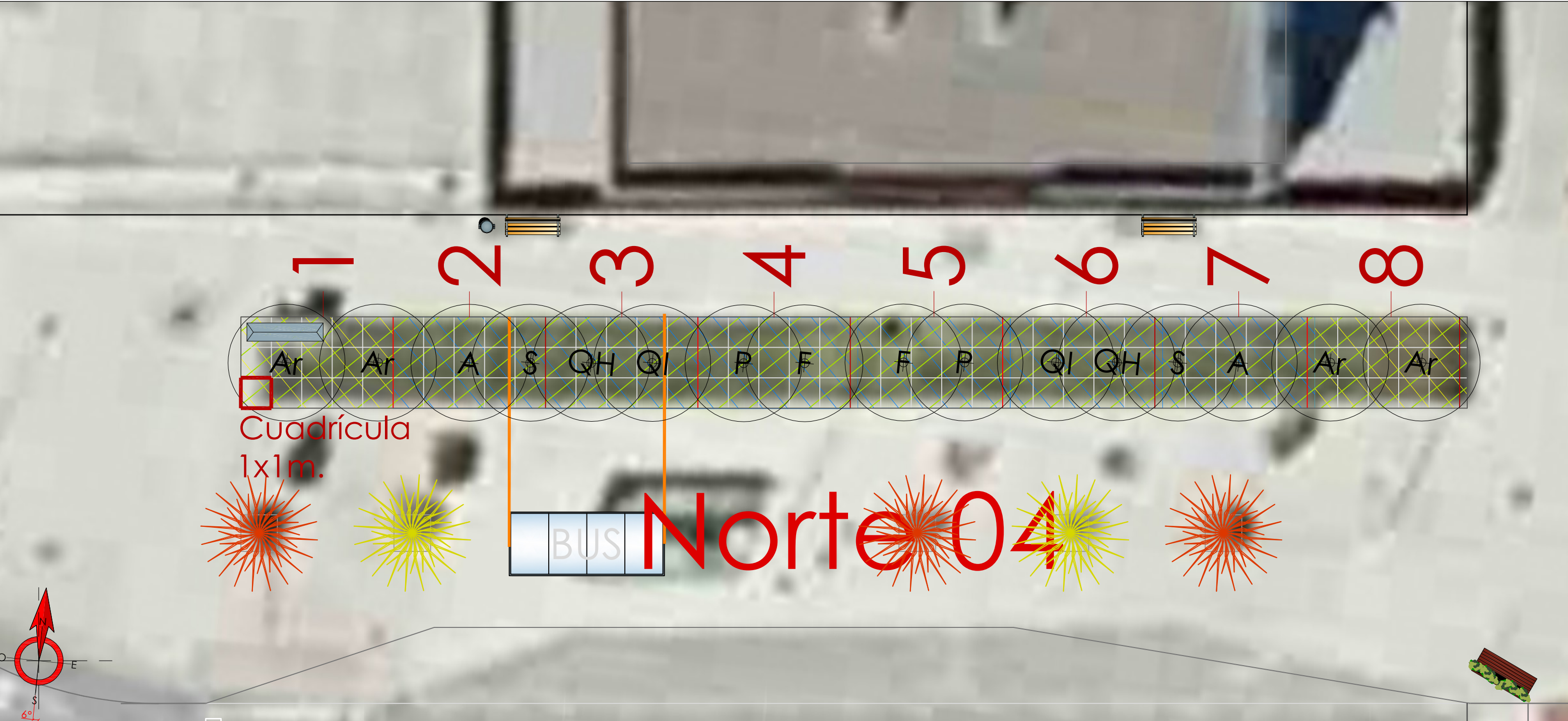
Replanteo módulo 1x1m según densidad de plantación. Estimación de la distribución de los emisores de goteo.
