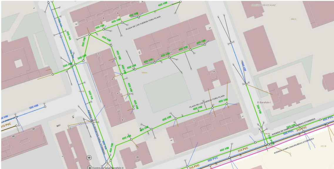
Red de saneamiento existente en la Plaza de los Fueros.
