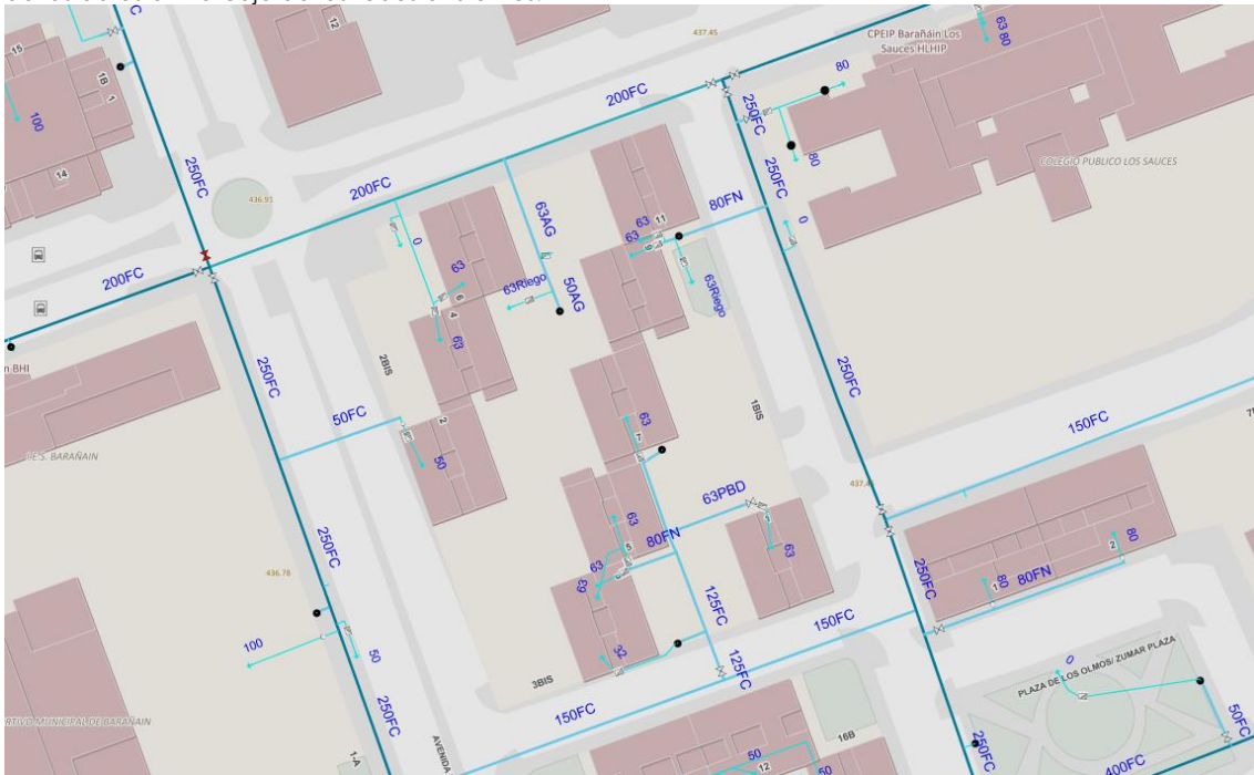
Red de abastecimiento existente en la calle San Esteban.
