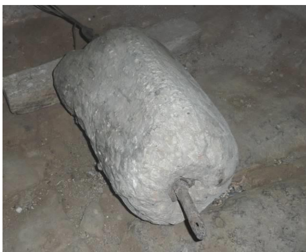
Pesa de piedra del antiguo reloj que se conserva en el nivel de la cámara abovedada. Fuente: IPV
