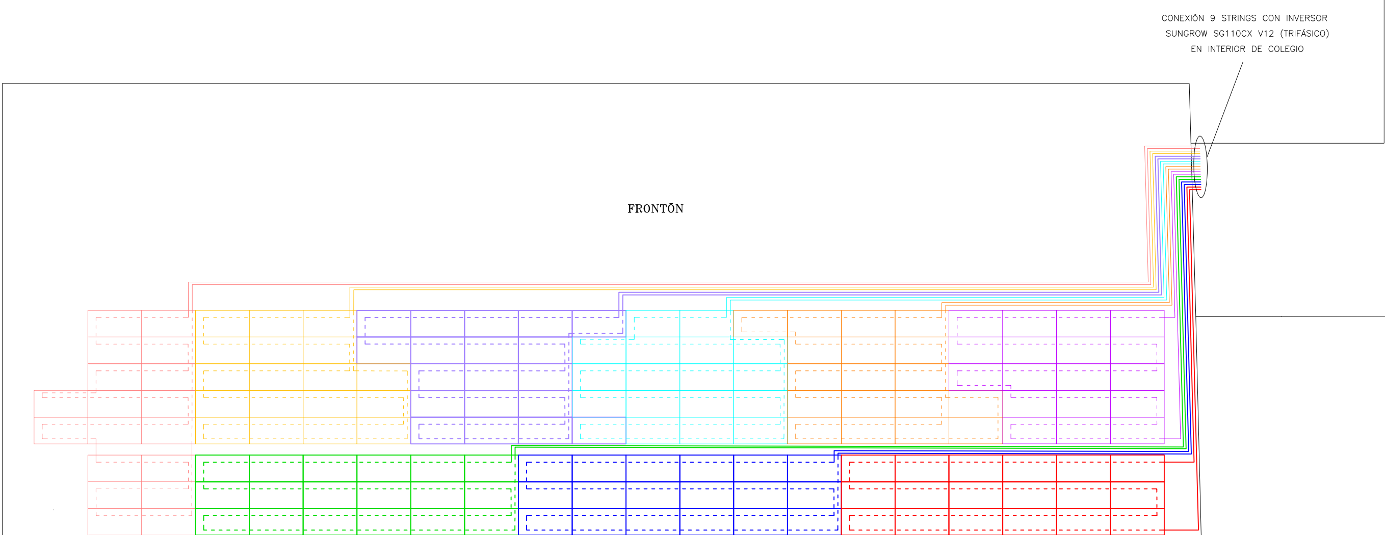
INSTALACIÓN 162 PANELES HORIZONTALES EN CUBIERTA FRONTÓN JETION 450Wp
