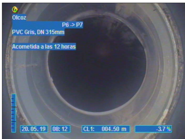
Fotografía: 3b 4,5m, Acometida a las 12 horas
