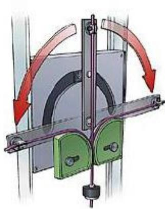
**Figura 16.- Ejecución de la prueba según EN 187000 Método 507.**
