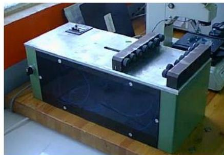
Figura 13.- Prueba de resistencia al quebrado de los tubos holgados.
