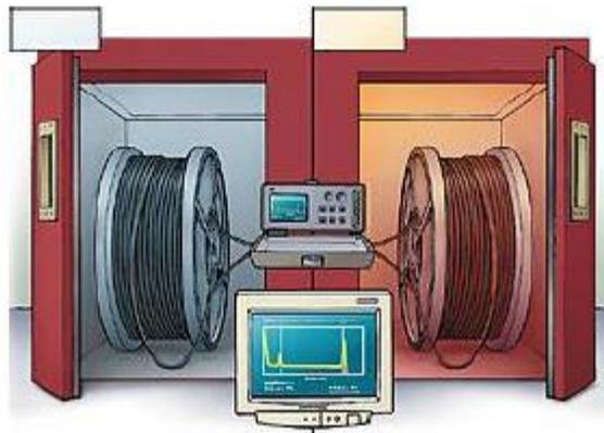
Figura 18.- Ejecución de la prueba según EN 187000 Método 601.
