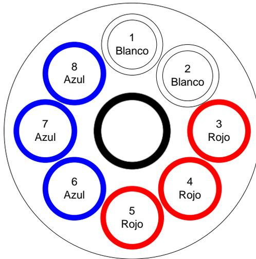
Figura 10 – Código de colores tubos del cable de 96 fibras ( 96x G.652 D)
