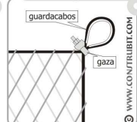
detalle de guardacabos
