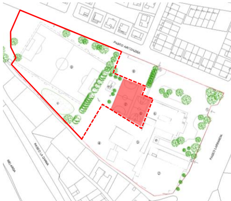
1. SOLERA DE HORMIGÓN – PISTAS DE FÚTBOL SALA Y BALONCESTO
