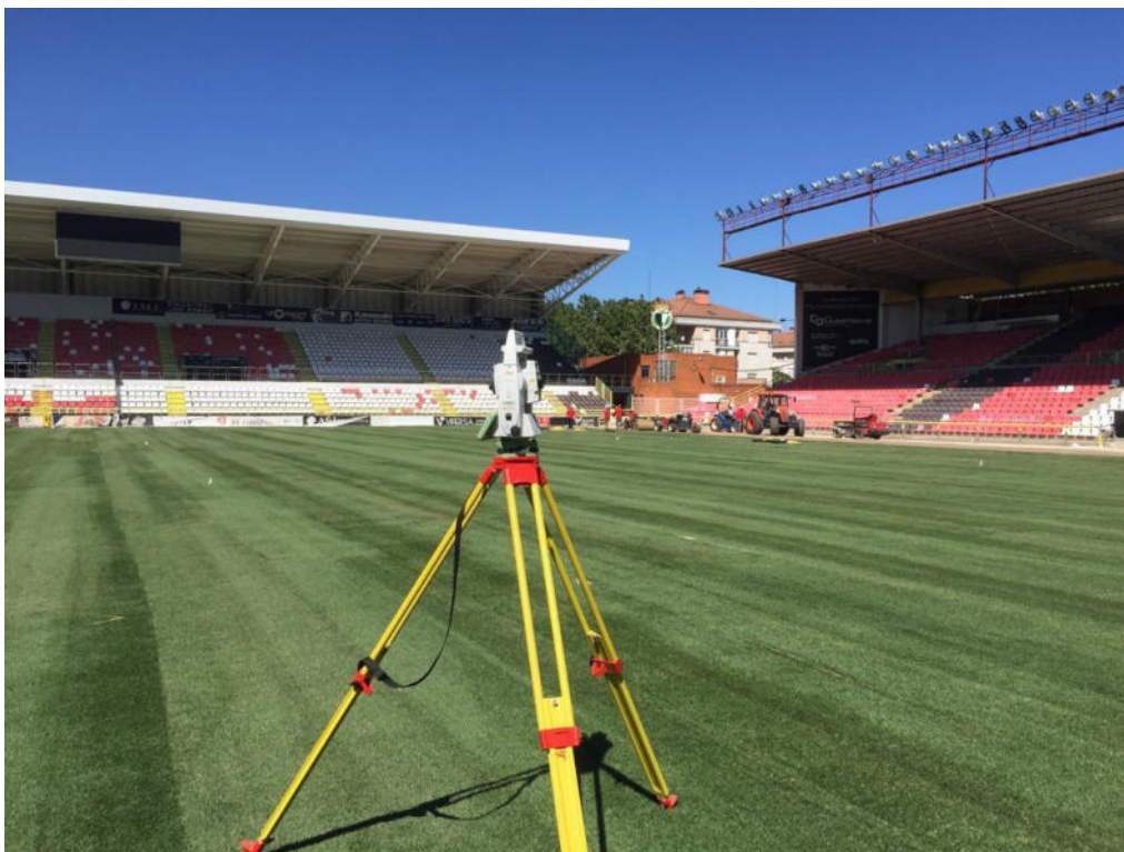
Imagen 4. Equipo de topografía robotizado Leica TS 30 para espacios cerrados.
