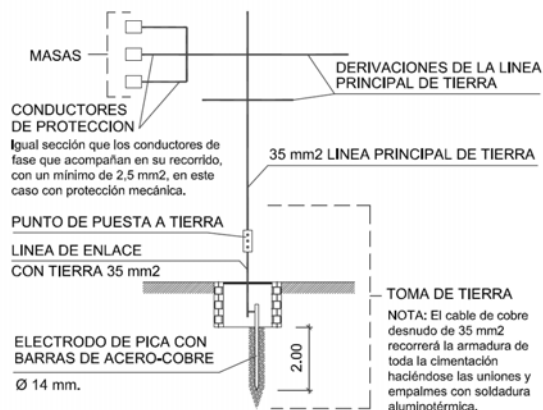
ESQUEMA DE PUESTA A TIERRA
