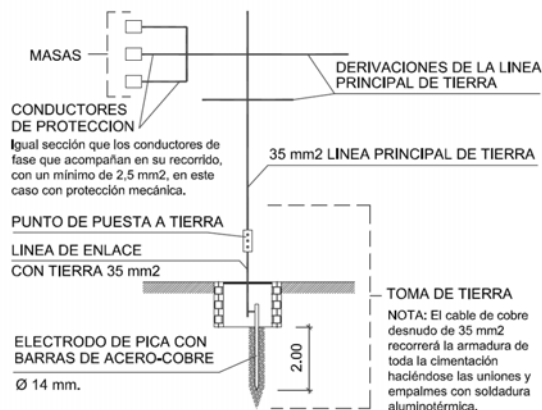
ESQUEMA DE PUESTA A TIERRA
