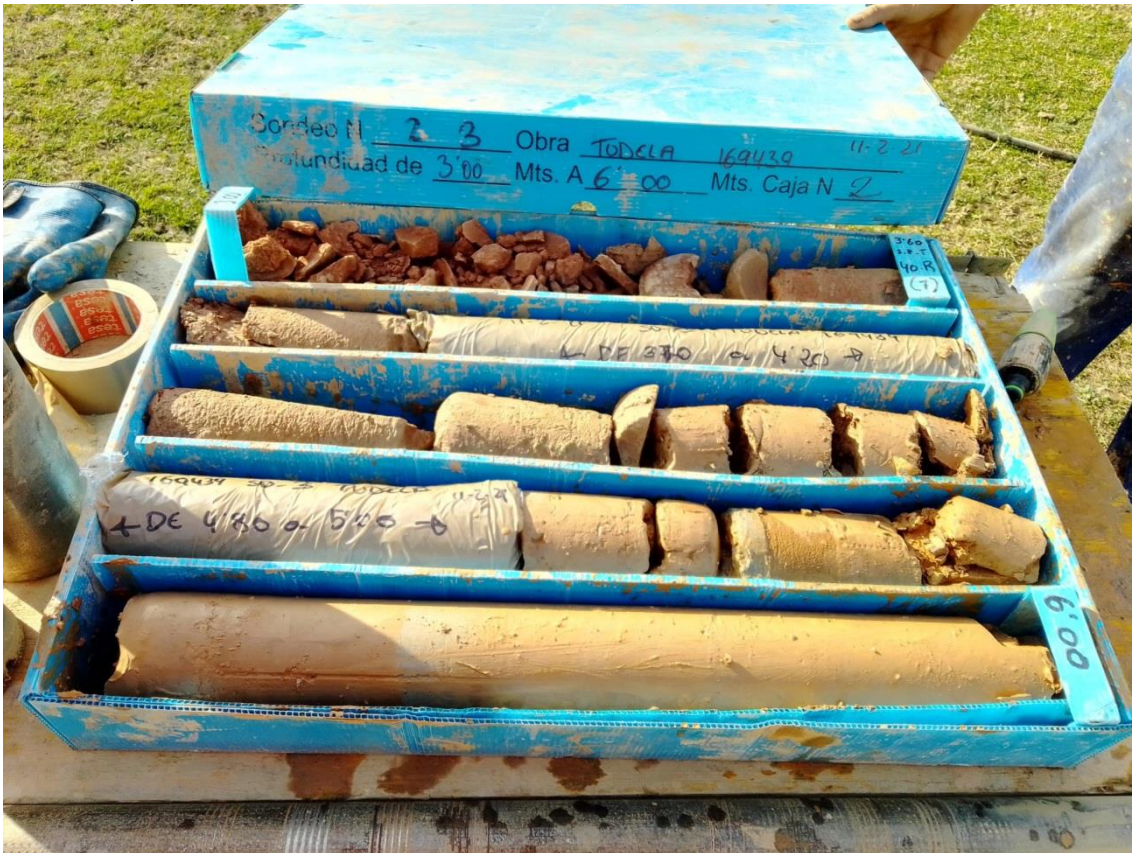
Sondeo 3, de 3 a 6 m.
