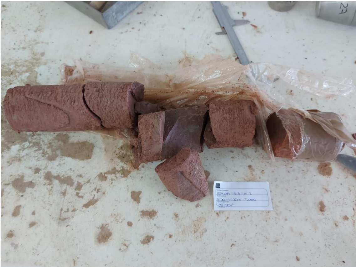
Muestra 2 del sondeo 1. Arcillas (argilitas) de la Fm Tudela. Se produce su rotura por diaclasado durante su tallado.
