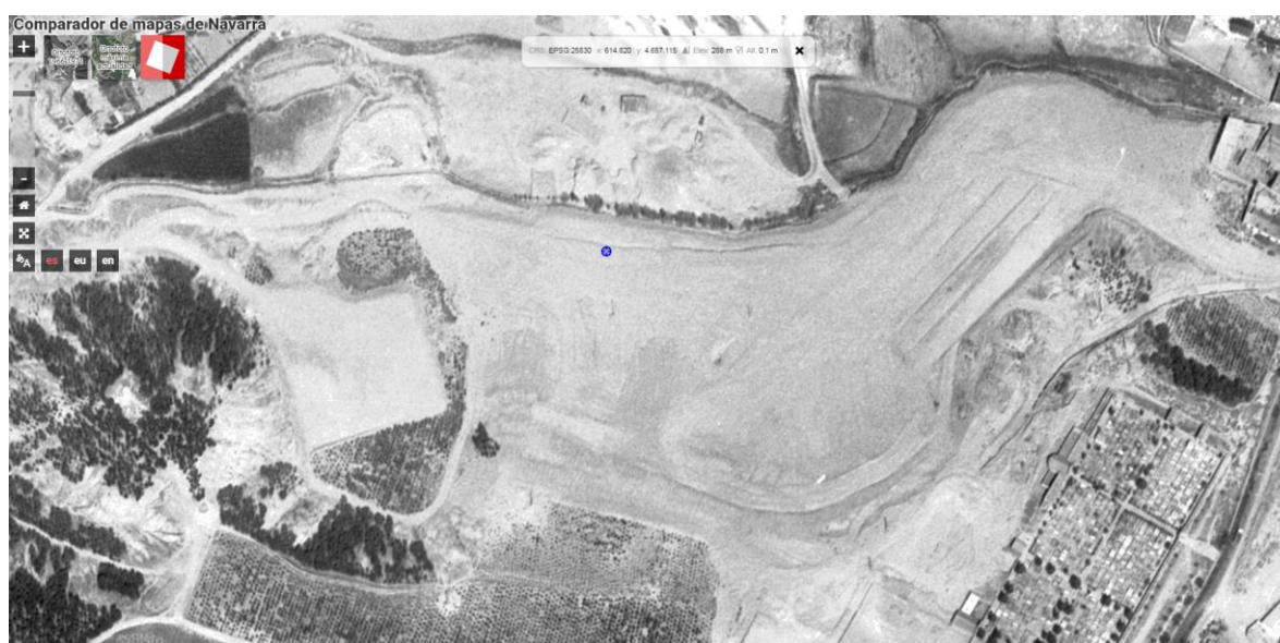
Ilustración 6: Fotografía aérea años 1966 - 1971. Se observa ya desmonte parcial y parece que el relleno de la zona noroeste (sondeo 1).
