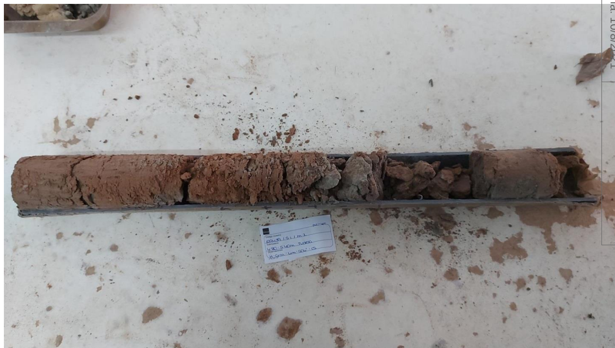
Ilustración 10: Material asignado a la UG 1, muestra inalterada del sondeo 1 entre 4,8 - 5,10 metros.
