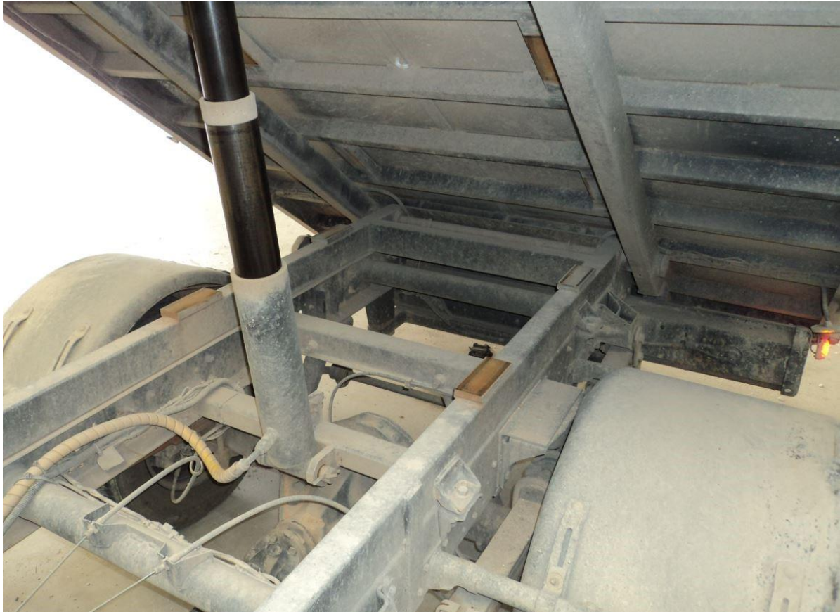
Fotografía 1: Bastidor carrocería paralelo exteriormente a falso bastidor.
