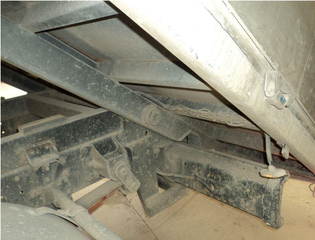
Fotografía 2: Detalle bisagra bastidor caja y falso bastidor.
