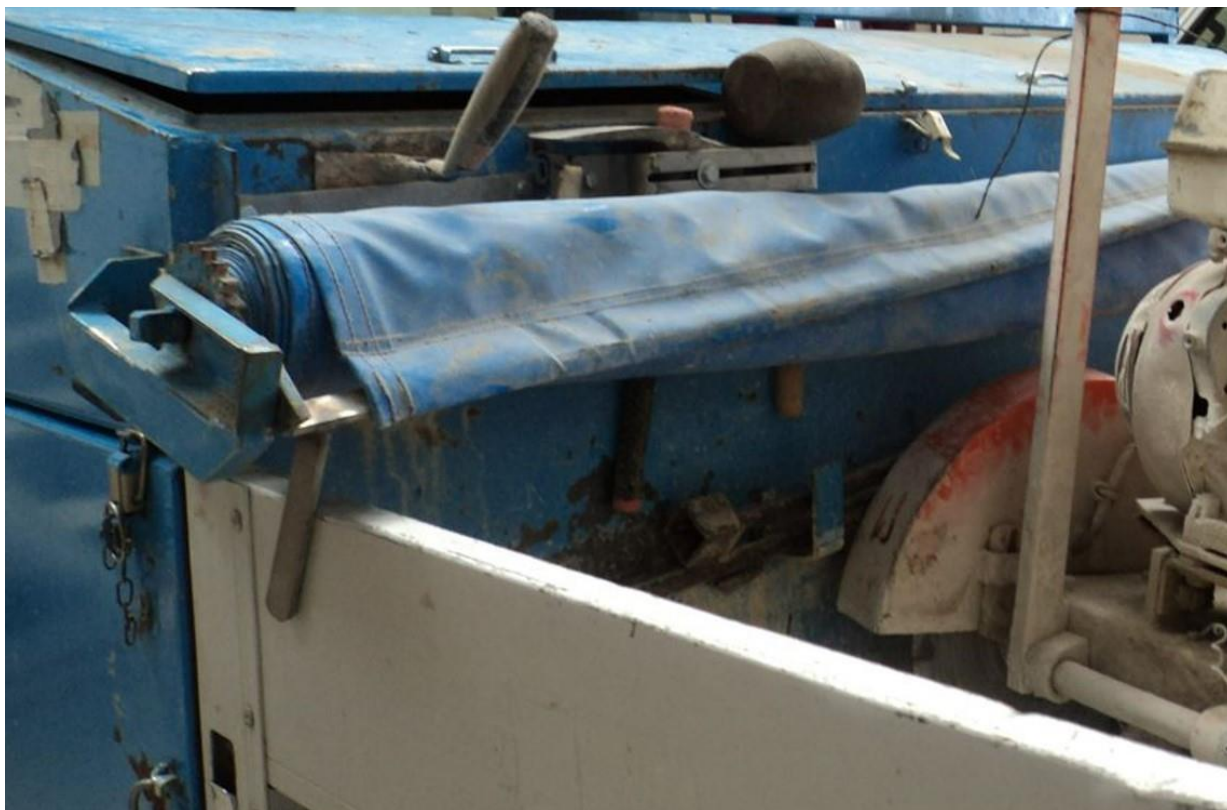
Fotografía 6: Detalle mecanismo de recogida.
