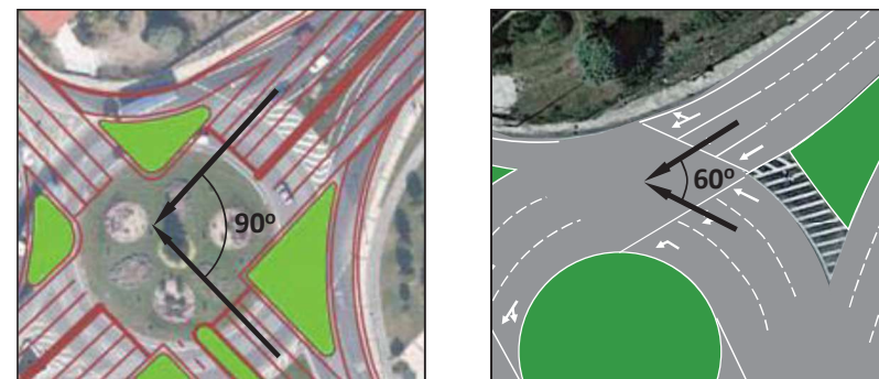
Fig. 18. Trayectorias en colisión frontolateral en la intersección en cruz y en la glorieta
