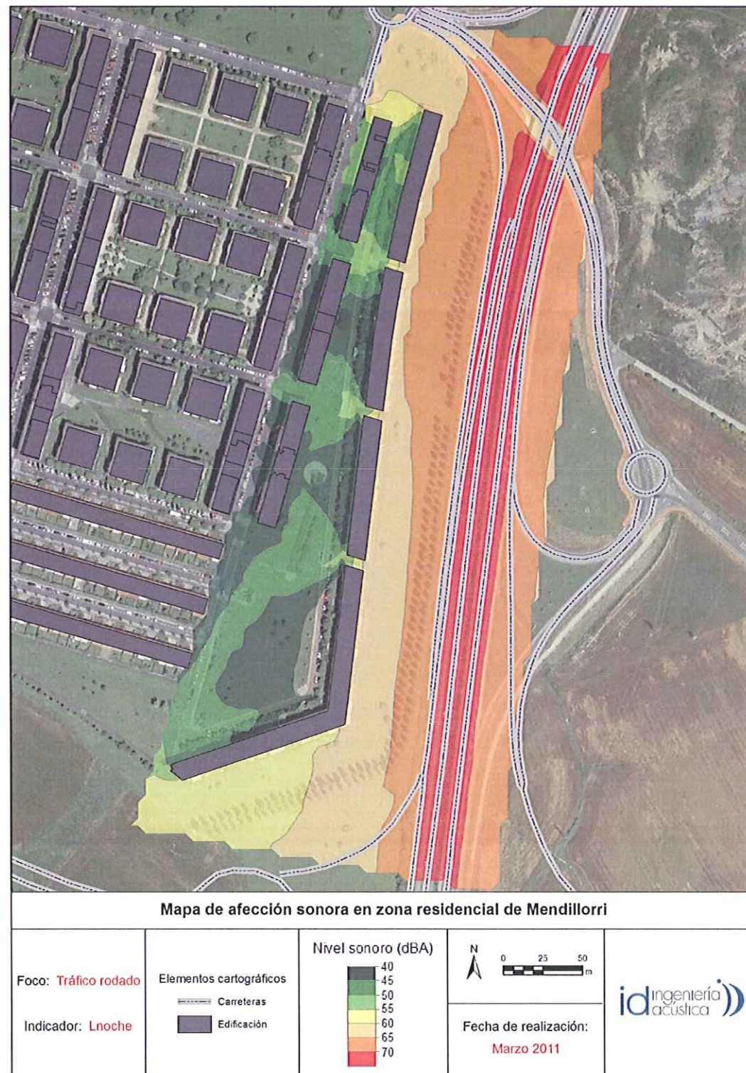
Fig. 3 Mapa acústico nocturno (Ln) a 4 metros sobre el terreno.
