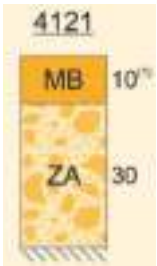
Figura 2. Paquete de firme zona glorieta
