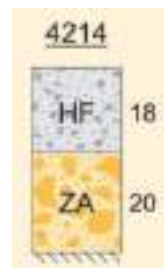
Figura 3. Paquete de firme del carril bus y aparcamientos de la travesía
