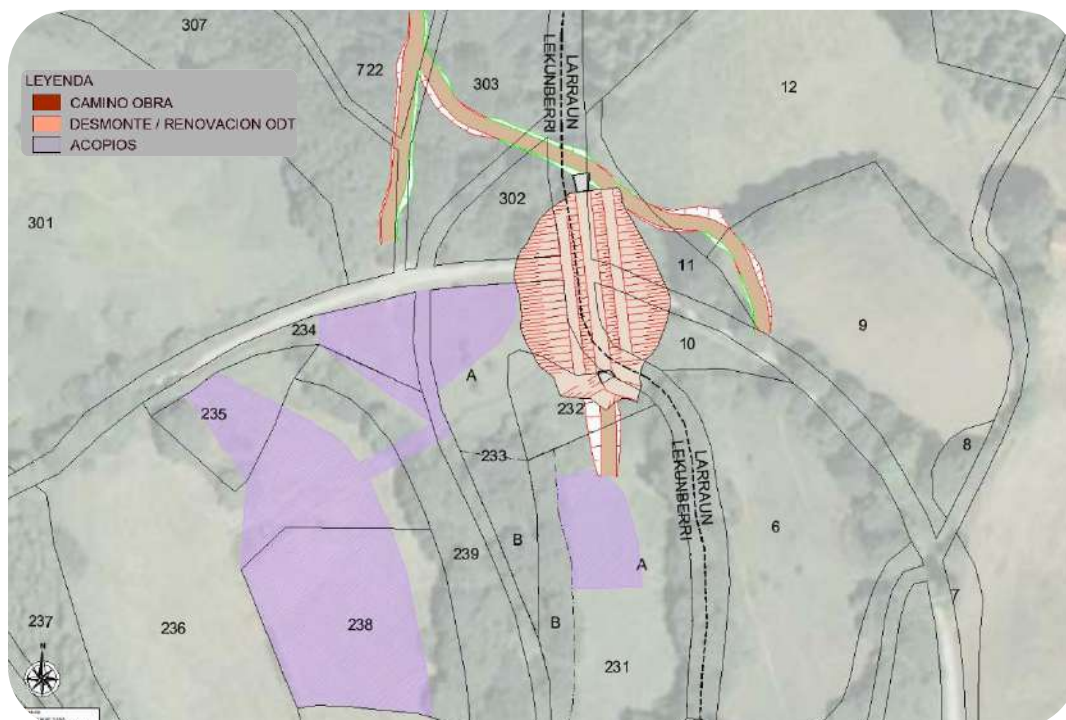
Fig. 13.1: Ocupaciones temporales por caminos de obra, acopios y ocupaciones directas de la ejecución de las obras.
