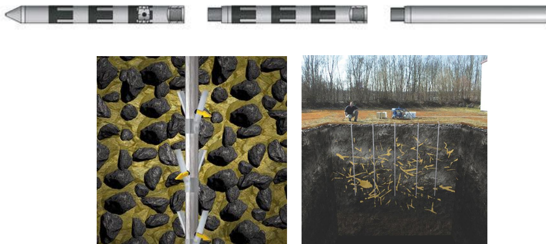
Esquema de inyección con lanzas hincadas con orificios laterales cubiertos.
