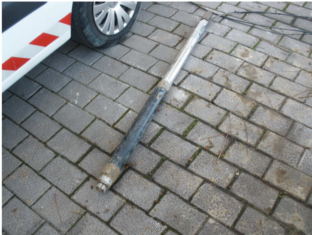
FOTO 10: Sonda empleada en los ensayos presiométricos.
