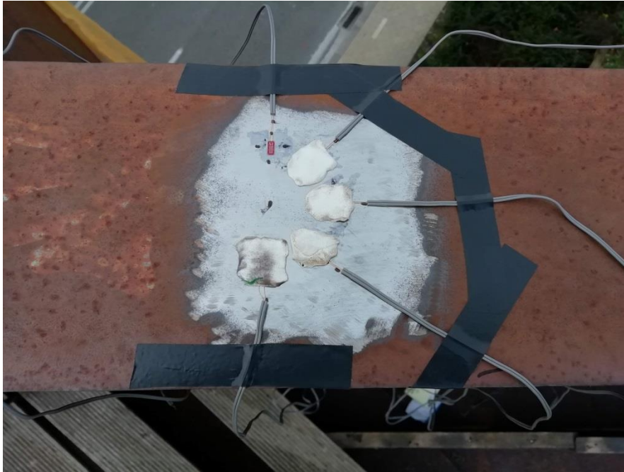
Ilustración 2. Hole-Drilling CI superior.
