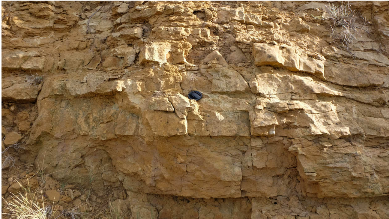
Imagen 3. Detalle del macizo rocoso en el escarpe superior del deslizamiento
