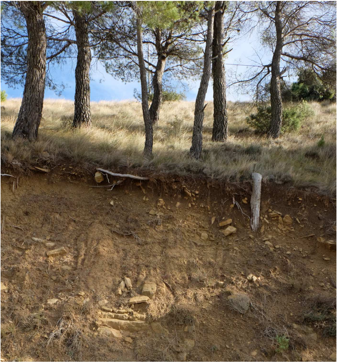
Fotografía: aspecto que presentan las acumulaciones de suelos. Se observa la presencia de bloques de diferente tamaño entro de una matriz de materiales finos, limos y arcillas.
