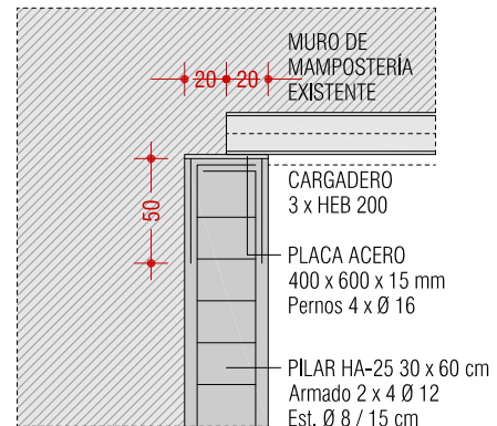
PILAR P7 SECCIÓN VERTICAL
