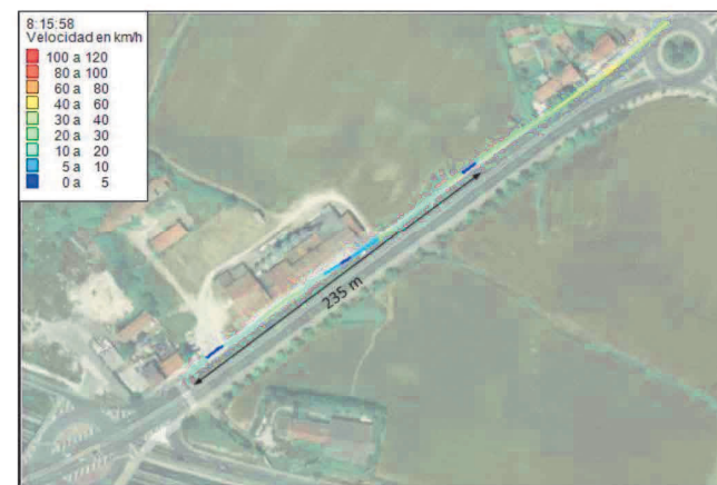
Imagen 8. Ejemplo del método de medición de colas mediante coche flotante.
