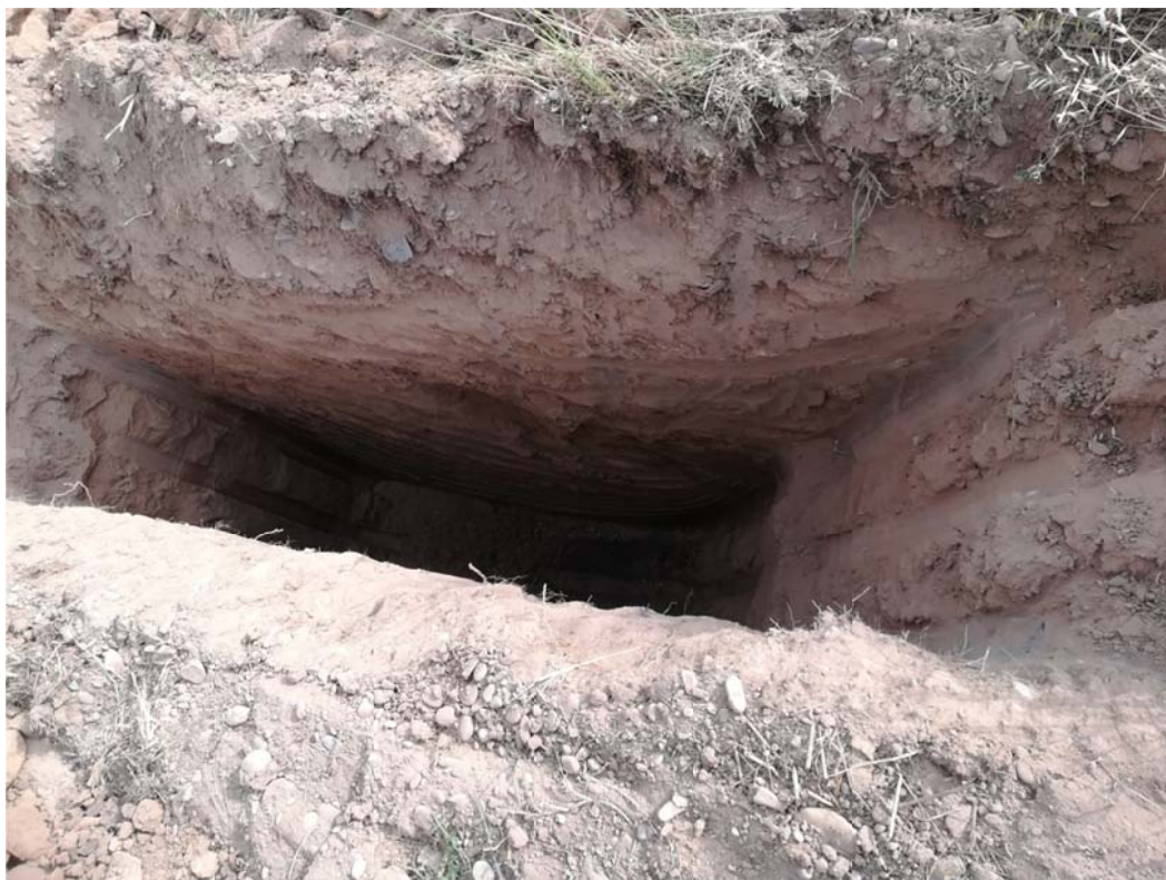
Fotografía nº7 – Perfil del terreno en calicata C-1.
