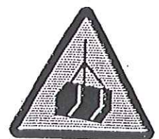
RIESGO CARGAS SUSPENDIDAS
