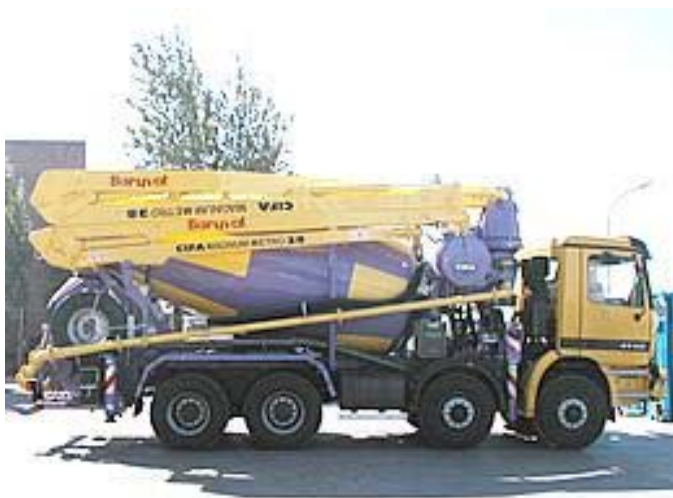
Camión Bomba Hormigonera
