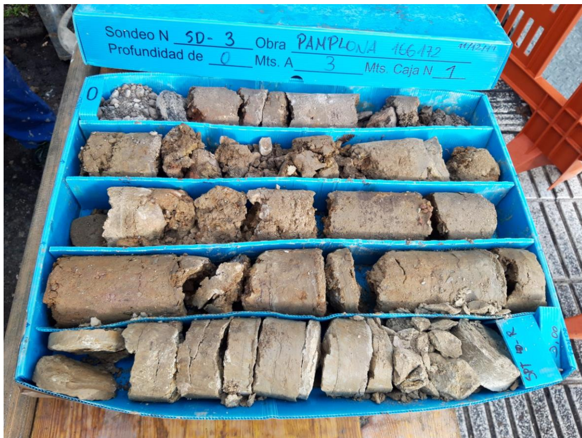
Sondeo 3, de 0 a 3 m.
