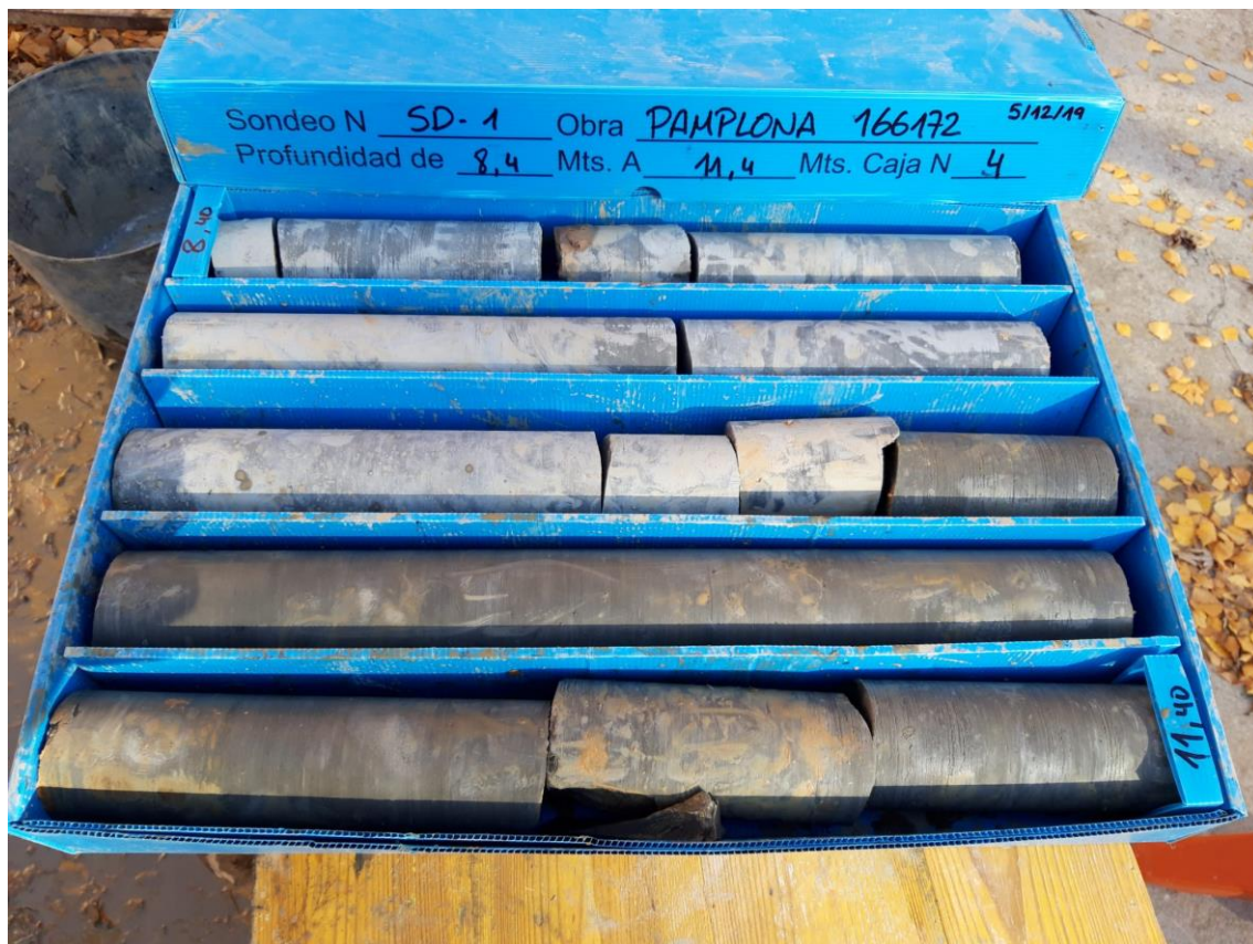
Sondeo 1, de 8,4 a 12 m.
