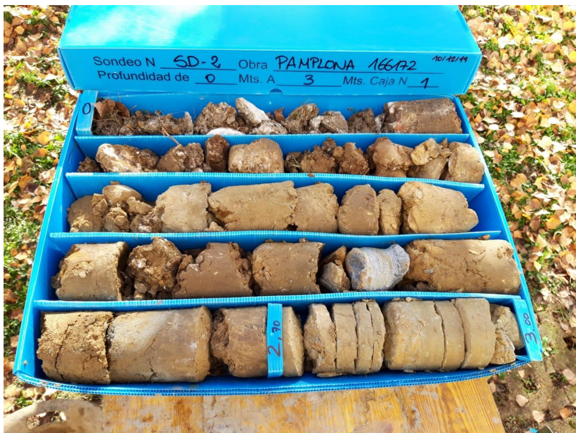
Sondeo 2, de 0 a 3 m.
