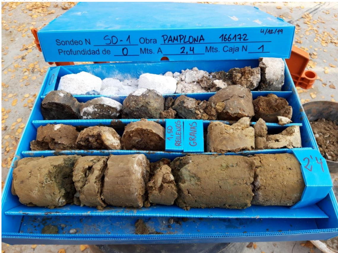
Sondeo 1, de 0 a 2,4 m.
