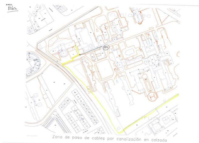
Imagen 6. Esquema red fibra óptica recinto CHN
