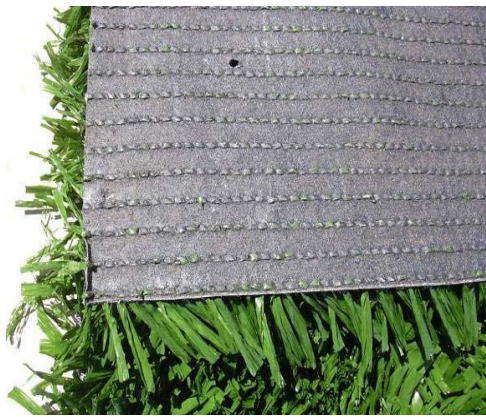
Figura 9: La separación de la junta de unión entre rollos debería ser igual a la distancia de separación entre puntadas.
