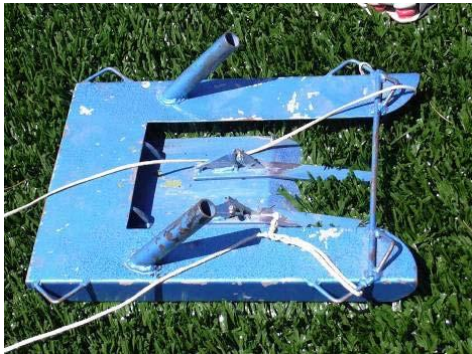
Figura 21: Herramienta utilizada para realizar el corte del césped, para colocar las líneas de marcaje.
