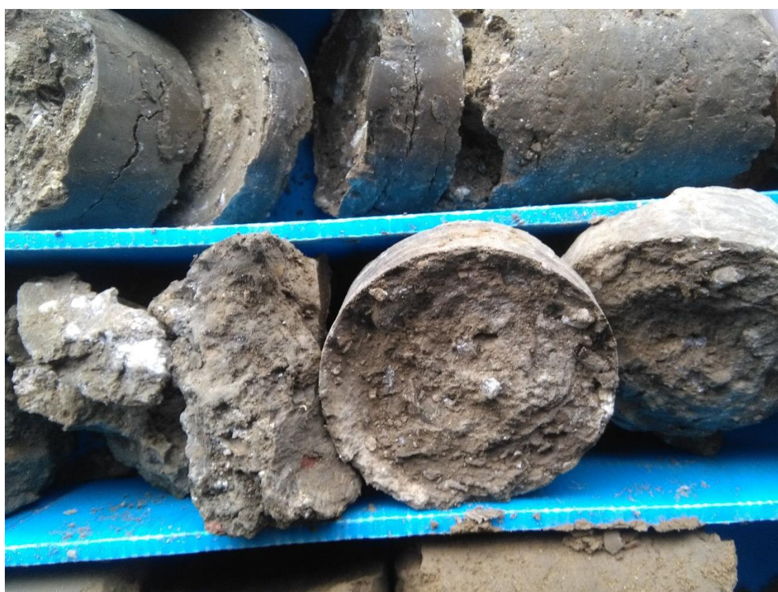
Detalle de los rellenos (fotos tomadas entre 1,80 y 2,40 metros) donde se observan arcillas con yesos, nódulos de yesos y trozos de ladrillos.
