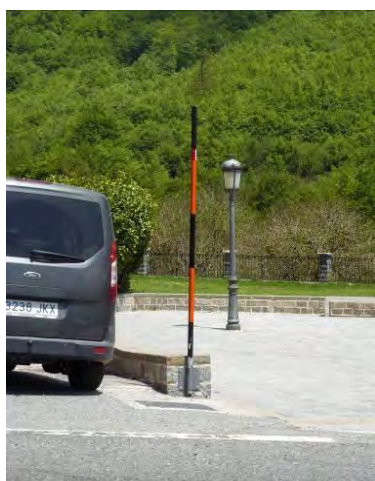
Ejemplo de baliza de nieve colocada para marcar la presencia de un murete en Roncesvalles
